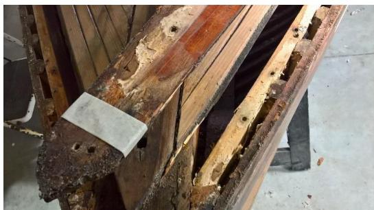
**Petite attaque de mérulé sous le pont juste derrière l'étrave,
