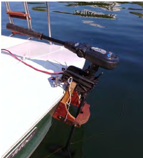
Moteur électrique hors-bord de secours
