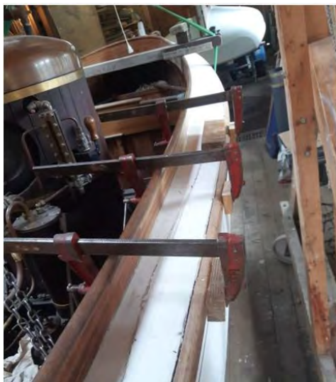
Rattrapage de la fissure par serre-joints
