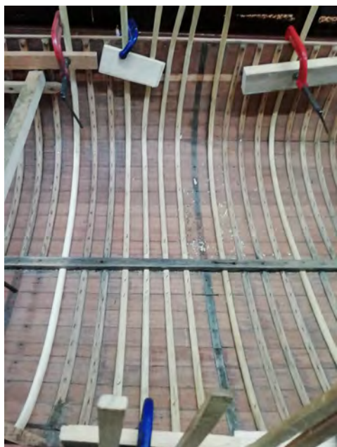
Remplacement des membrures
